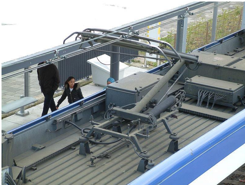
... als alternatief voor de wereldwijd gebruikte pantograaf met sleepstuk, hier op een RandstadRail tram, foto:
